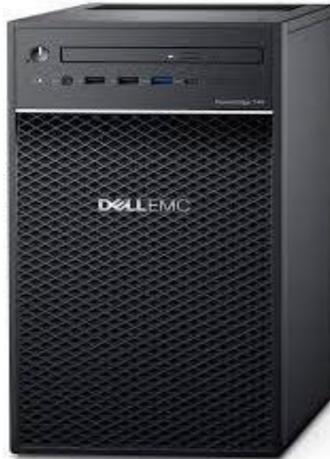
Рисунок 2.5 – Сервер Dell PowerEdge T40, використаний для розміщення сервісів та резервування даних
