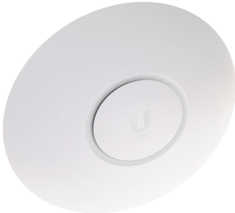
Рисунок 2.4 – Точка доступу Ubiquiti UniFi 6 Lite (Wi-Fi 6) для організації корпоративної бездротової мережі
