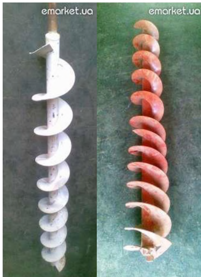
Рисунок 3.1 - Шнек типу РСМ 10.01.47.020 (зерновий)
