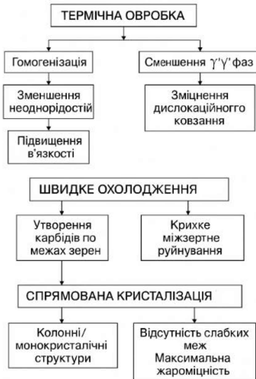
Рисунок 2.1 – Схема впливу обробки на механізми зміцнення
