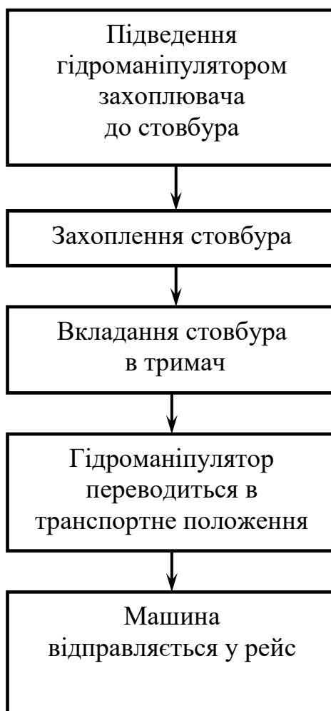
Рисунок 2.1 – Структурна схема роботи модернізованої машини
