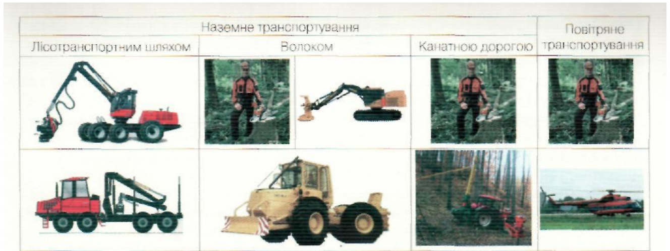
Рисунок 1.1 – Комплекси лісових машин з використанням різних способів транспортування деревини [9]
