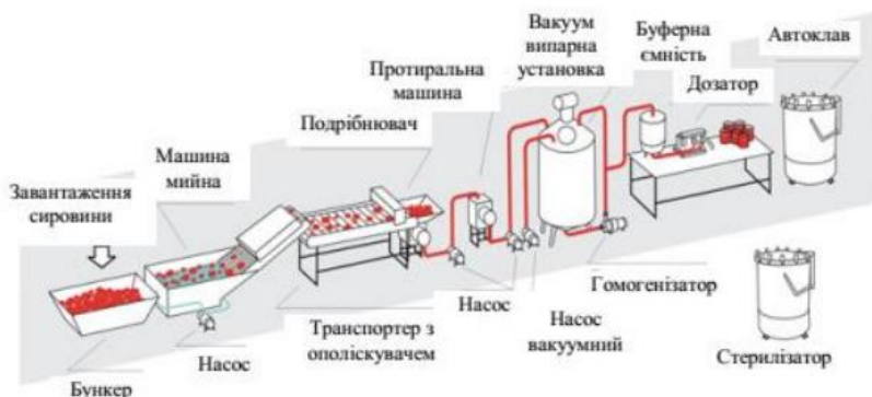
Рисунок 6.7 – Апаратно-технологічна схема виробництва концентрованих томат-продуктів
