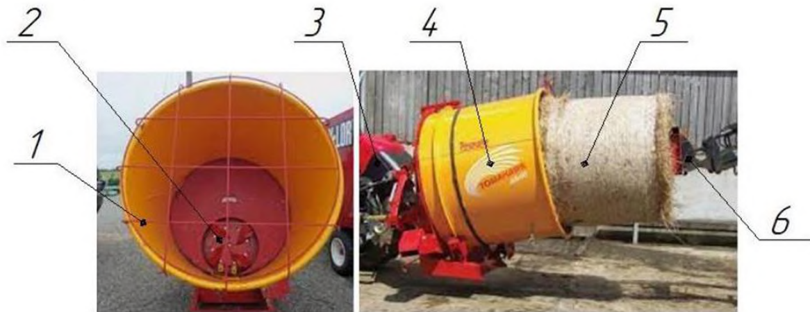
Рисунок 1.4. Подрібнювач рулонів: 1 – захисний кожух, 2 – ніж, 3 – навіска трактора, 4 – рулон, 6 – навантажувач.
