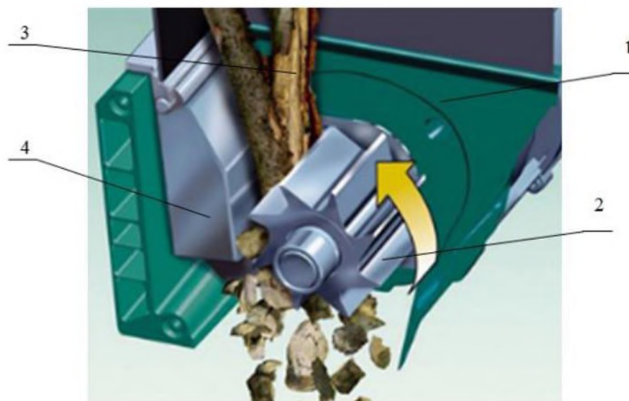
Рисунок 1.1 – Подрібнювач для кущів та малої деревини: 1 – корпус, 2 – ніж, 3 – деревина, 4 – протирізальна пластина
