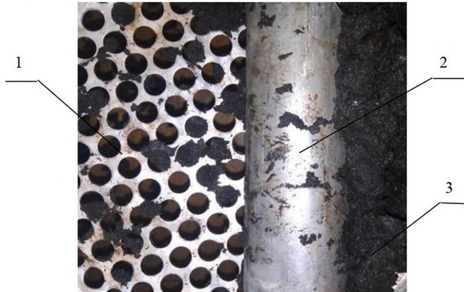
Рисунок 3.7 – Фото процесу подрібнення суцільної маси ОМС на самостійні частинки: 1 – перфорований циліндр; 2 – ролик (коток); 3 – ОМС
