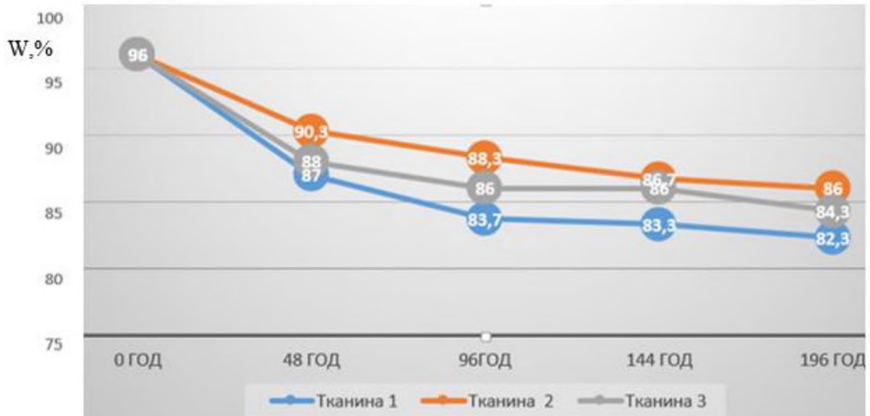
Рисунок 3.5 – Графічна залежність зміни показника вологості сапропелю від часу відлежування, за різних тканин з яких виготовляли геотуб
