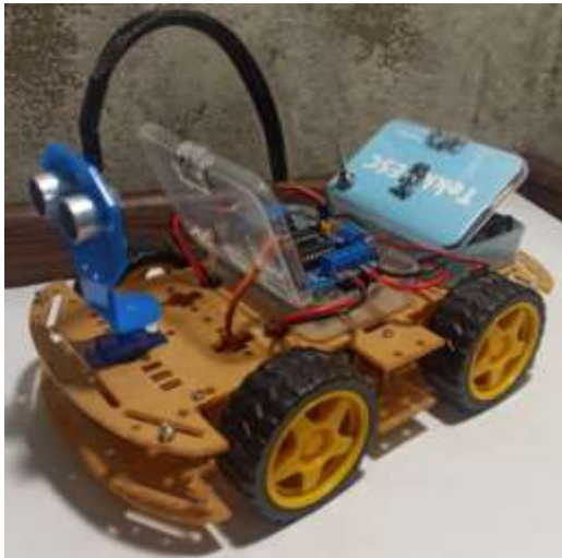
Рис. 3 Апаратна модель мобільного робота-автомобіля що обминає перешкоди
