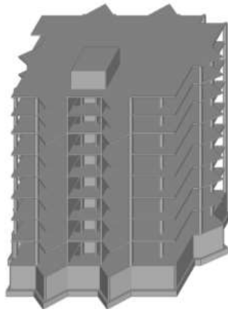
Рис. 2.1. Конструктивно-розрахункова схема монолітної житлової споруди
