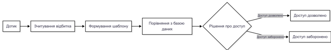
Рисунок 1.8 – Схема роботи розпізнавання відбитку
