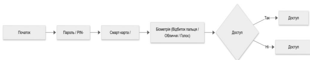
Рисунок 1.5 – Комбінована система контролю доступу: багаторівнева перевірка користувача
