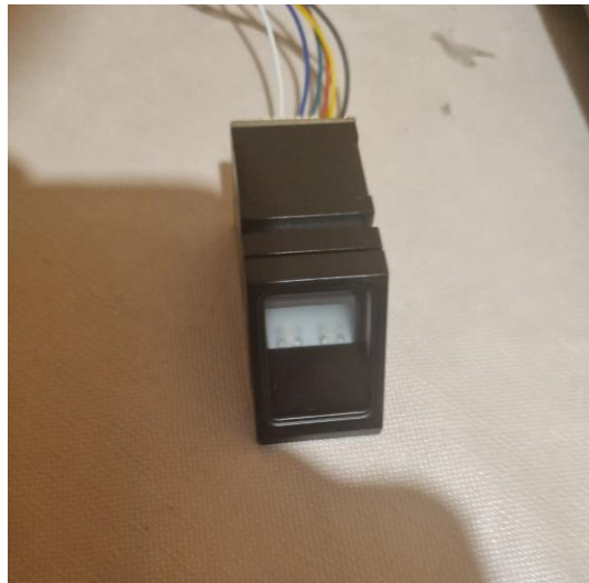
Рисунок 3.3 – Сканер відбитка пальця для забезпечення другого рівня аутентифікації
