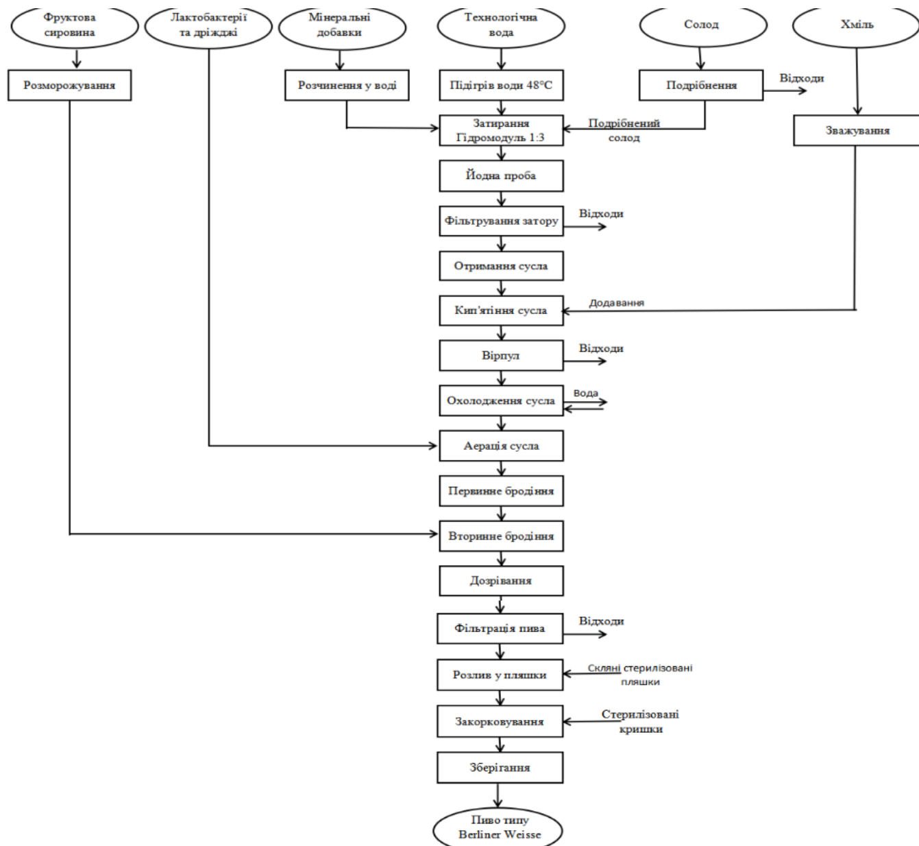
Рисунок 4.2 – Технологічна схема виробництва фруктово-ягідного пива типу Berliner Weisse
