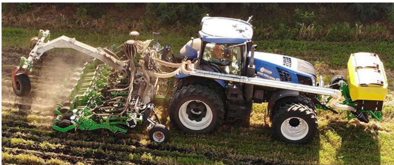
Рисунок 1.9 Фото сівалки STS Magia із бункерами навішеним на передню навіску трактора [5]
