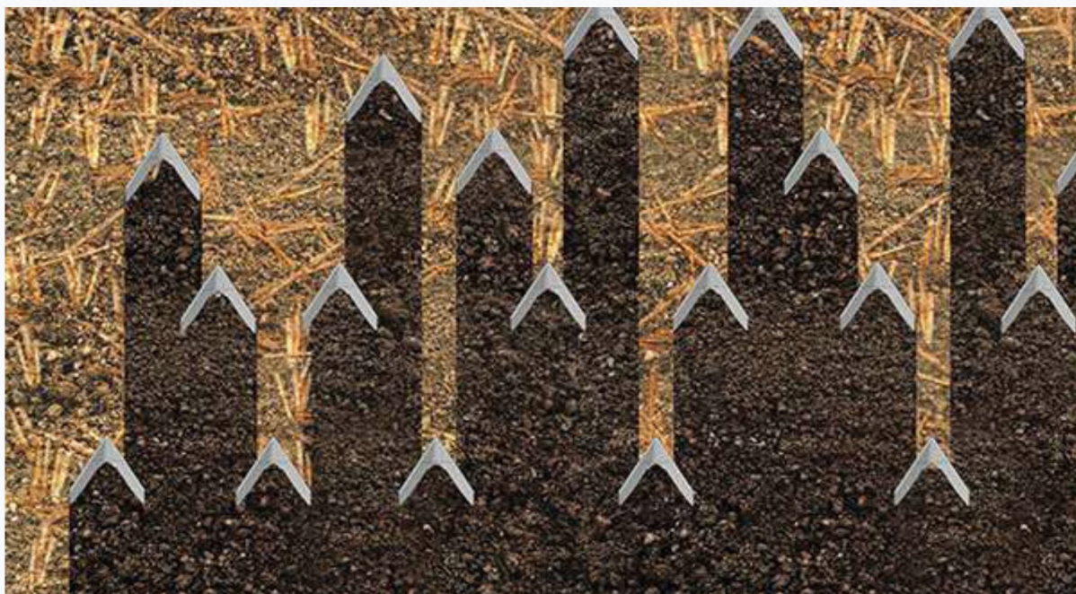
Рисунок 1.5 Схема роботи лап-сошників сівалки ALCOR 7,5
