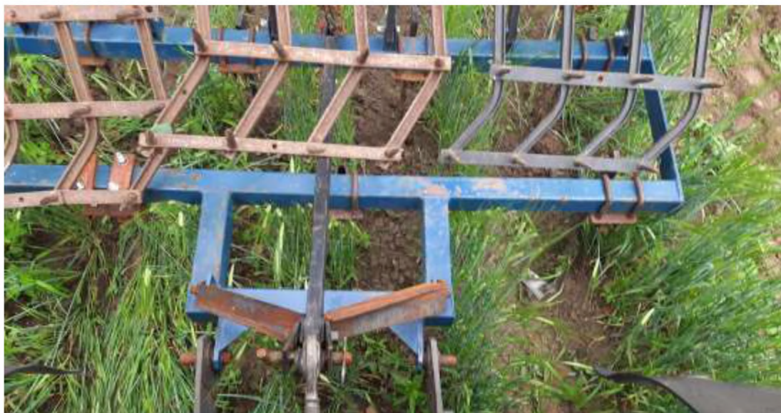
Рисунок 3.6 Фото міжрядного обробітку смугового посіву ячменю культиватором КУ-1,6
