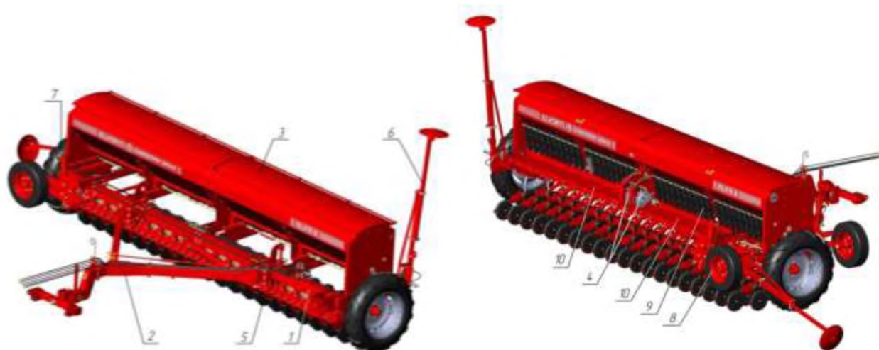
Рисунок 1.1 Сівалка ALFA 6 [4]: 1 – рама; 2 – причіпний пристрій; 3 – зерно-туковий бункер; 4 – варіатори; 5 – сошник; 6 – маркер; 7 – опорно-приводне колесо; 8 – колесо для транспортування; 9 – висівний апарат; 10 – підніжна дошка; 11 – ланцюговий загортач
