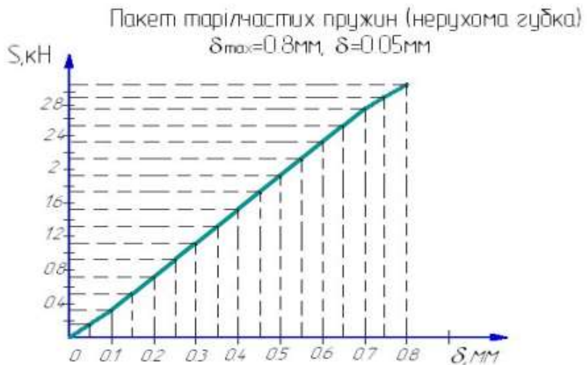
Рисунок 4.2 – Графік залежності деформації пакету тарілчастих пружин від осадки \delta елемента пружини
