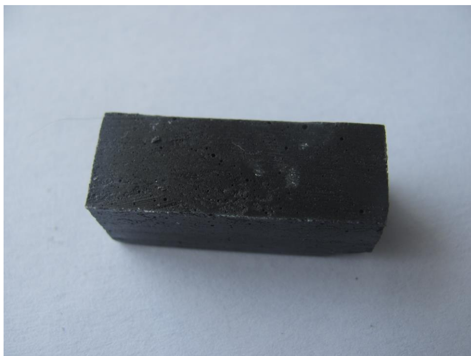
Рисунок 2.2 – Загальний вигляд зразків для дослідження триботехнічних характеристик
