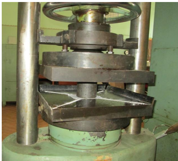
Рисунок 7.6 – Гідравлічний прес під час випробування зразків
