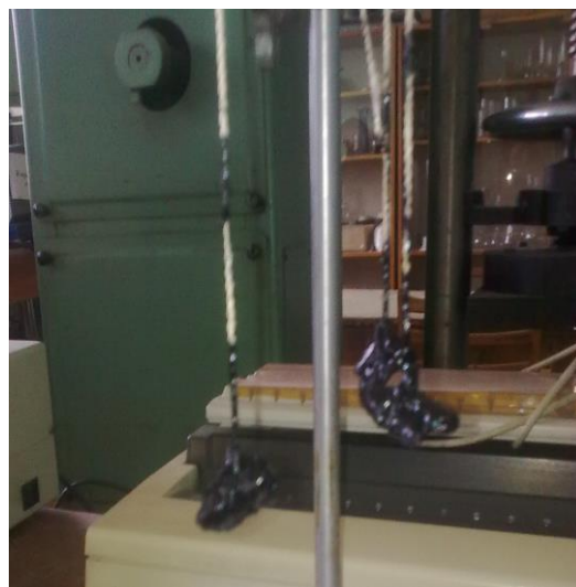
Рисунок 7.1 – Зчеплення щебеню з бітумом:
