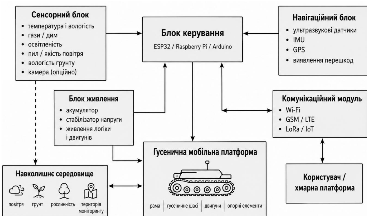
Рисунок 1.2 - Узагальнена структура гусеничної мобільної платформи для екологічного моніторингу [2]
