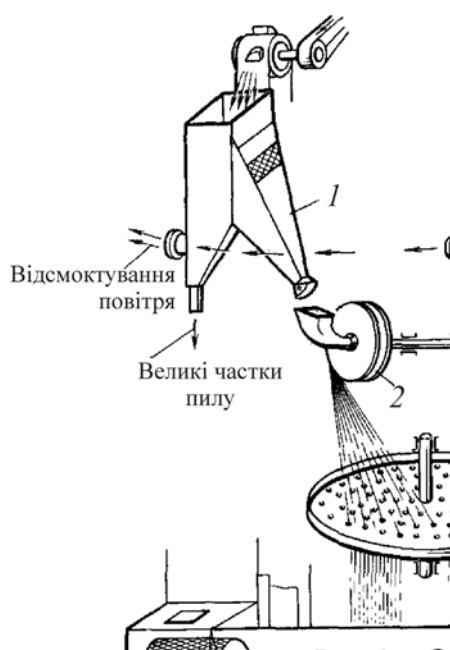
Рисунок 1.16 Принципова схема дробометальної очисної машини:
