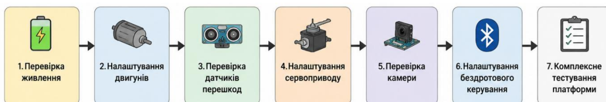
Рисунок 3.6 – Послідовність налаштування модулів мобільного робота
