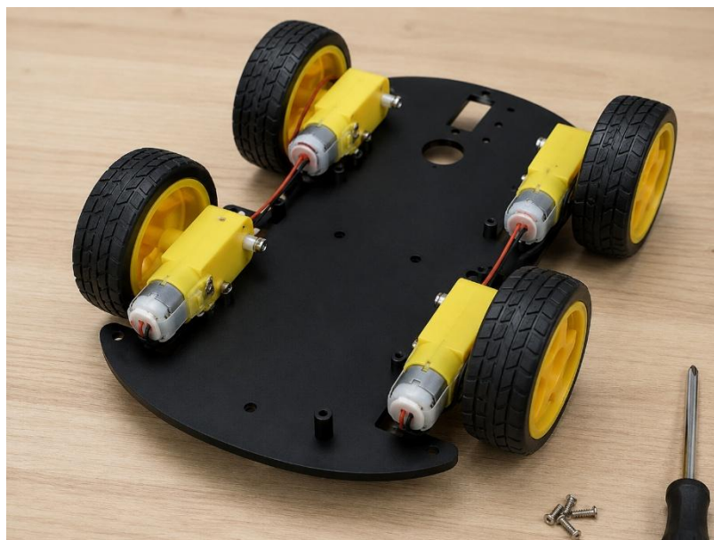
Рисунок 3.3 – Формування ходової частини мобільного робота
