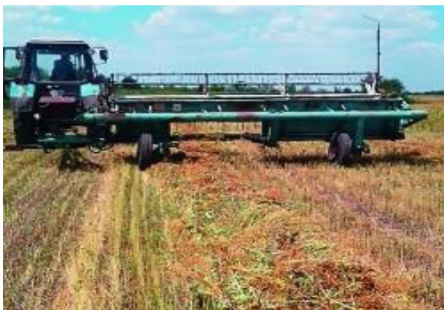
Рисунок 1.4 Скошування льону олійного у валки
