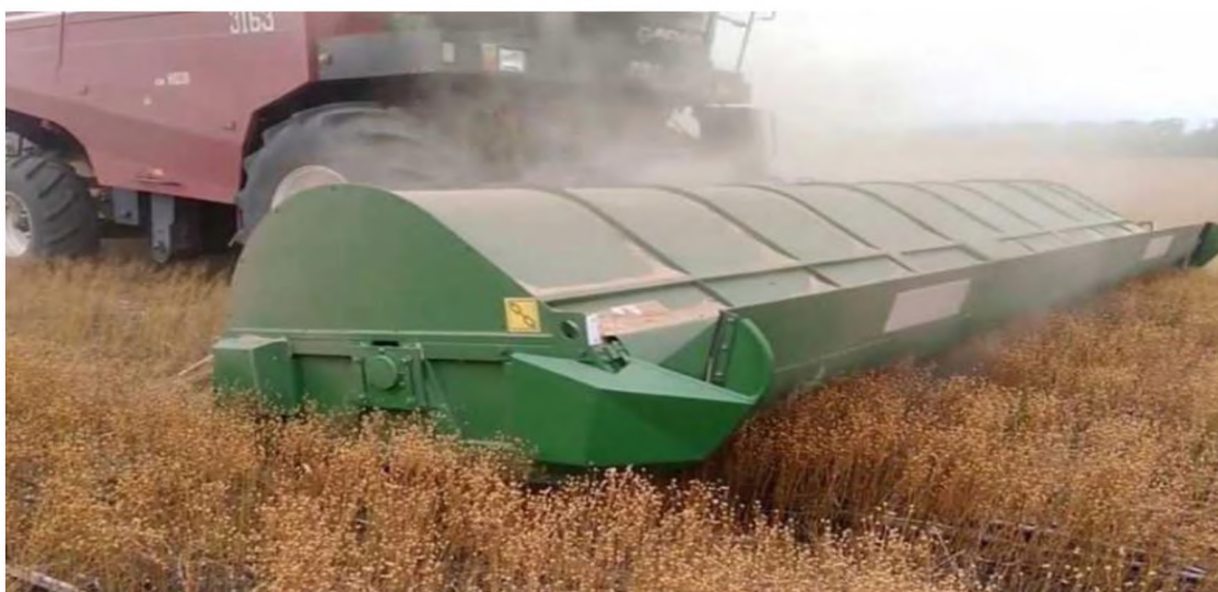
Рисунок 1.9 Обчісувальна жатка зернозбирального комбайну для збирання льону олійного
