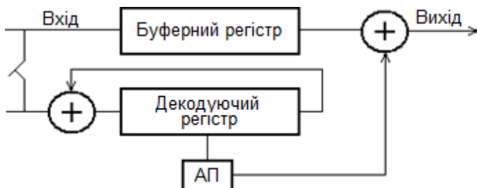
Рисунок 8.2 – Схема декодування циклічного коду.
