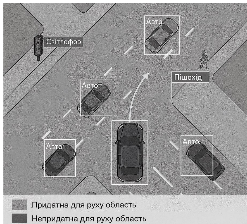
Рисунок 1.12 – Карта оточення автомобіля з результатами виявлення об'єктів, сегментації придатної для руху області та оцінювання відстані [21]
