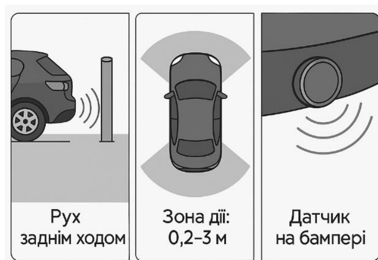
Рисунок 1.4 – Приклад роботи ультразвукових датчиків у ближній зоні автомобіля [10]
