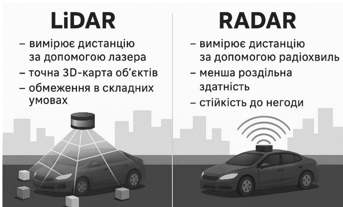
Рисунок 1.3 – Порівняння сенсорів LiDAR та RADAR [9]
