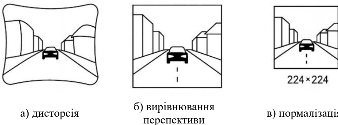
Рисунок 1.8 – Етапи геометричної корекції та нормалізації зображення в системах автономного водіння [13]
