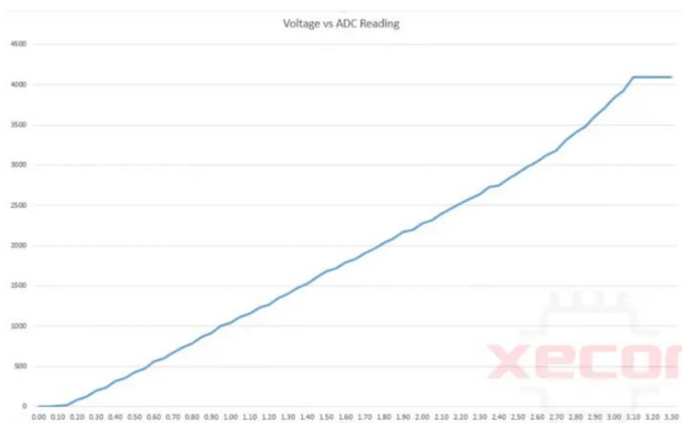
Рисунок 2.2 – Нелінійність АЦП на краях діапазону напруги [2]
