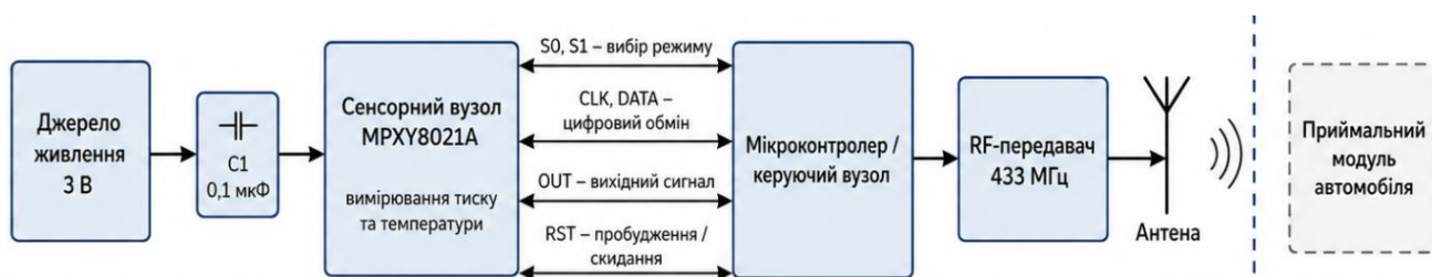
Рисунок 2.2 – Функціональна схема автономного TPMS-датчика, розроблено автором на основі [33]
