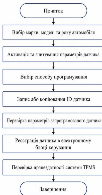
Загальна послідовність програмування та налаштування TPMS-датчика
