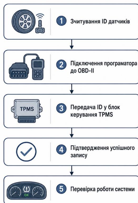
Рисунок 3.5 – Послідовність OBD-навчання TPMS-датчиків
