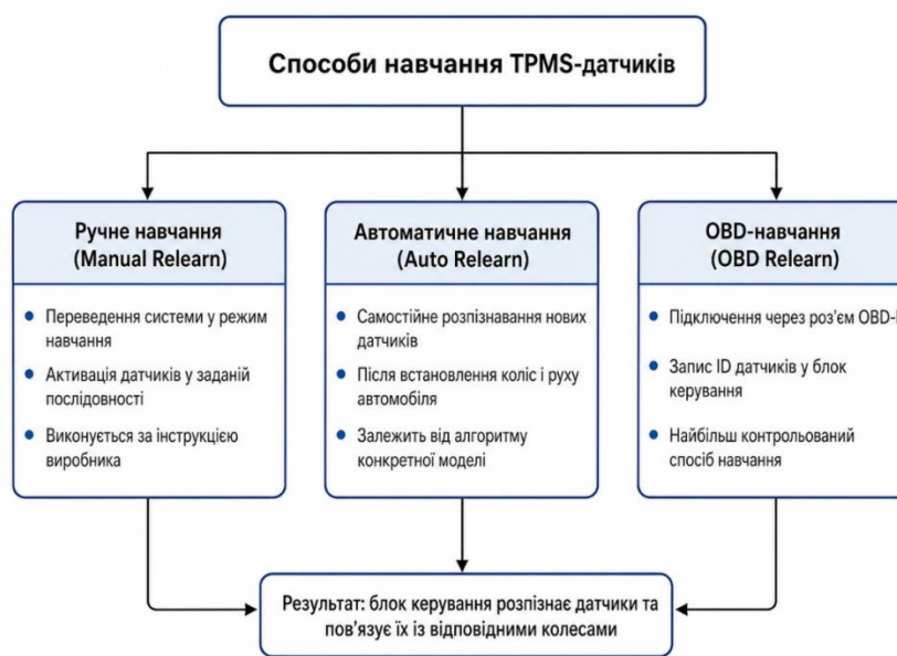
Рисунок 3.6 – Способи навчання TPMS-датчиків у блоці керування автомобіля, розроблено автором на основі [18], [22], [28]
