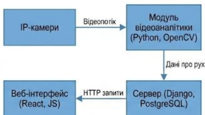
Рисунок 2.1 – Загальна архітектура системи моніторингу завантаженості автомобільних доріг
