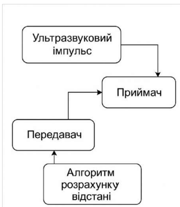
Рисунок 1.12 – Принципова схема роботи ультразвукового сенсора HC-SR04
