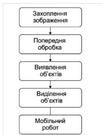
Рисунок 1.15 – Алгоритм виявлення об'єктів за допомогою OpenCV на прикладі мобільного робота
