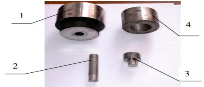
Рис. 4.2. Прес-форма циліндрична: 1 – матриця; 2 – верхній пуансон; 3 – нижній пуансон; 4 – втулка для випресування циліндричних зразків.
