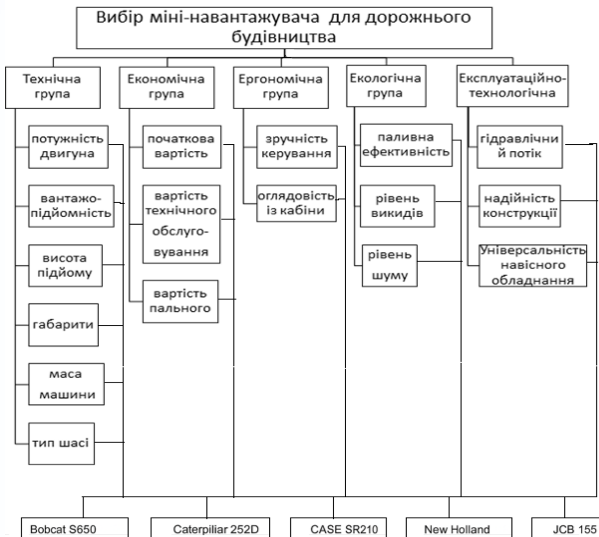
Рис. 1. Ієрархічна структурна модель проблеми вибору трактора для комунальної сфери
