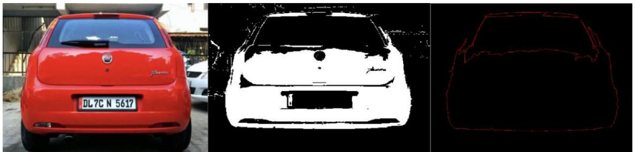
Рисунок 2.7 – Етапи обробки зображення при розпізнаванні кольору у методі isRed()
