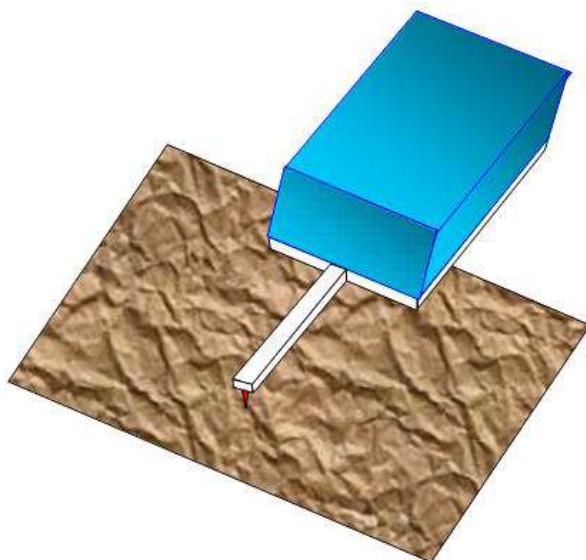
Рисунок 2.9 – Загальний вигляд зондового АСМ датчика з одиночною консоллю прямокутного перерізу
