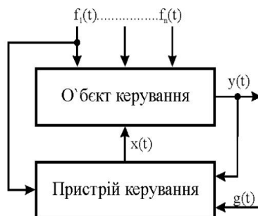
Рисунок 12 - Структура САК, побудованої на основі комбінованого принципу керування
