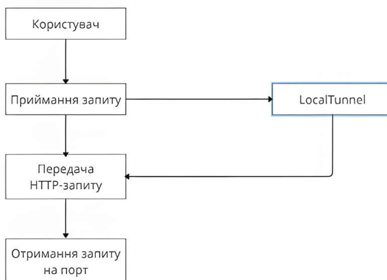
Рисунок 2.3 – Функціональна схема роботи тунелювання
