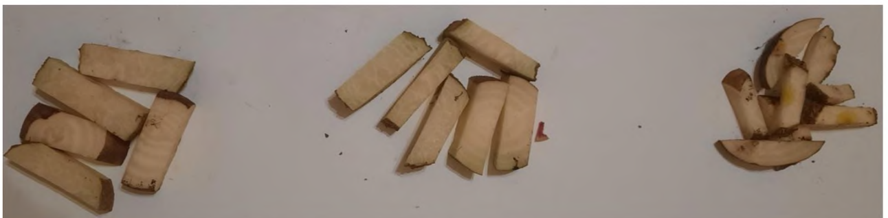
Рисунок 3.11 – Зразки кормового буряка для визначення зусиль різання
