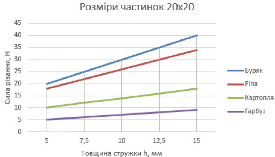
Рисунок 3.15 – Графік залежності зусилля різання отриманих частинок з гарбуза, картоплі, редьки та кормового буряка розміром 20-20 мм.
