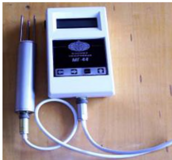
Рисунок 3.2 Вологомір для визначення вмісту вологи в сільськогосподарських матеріалах МГ-44
