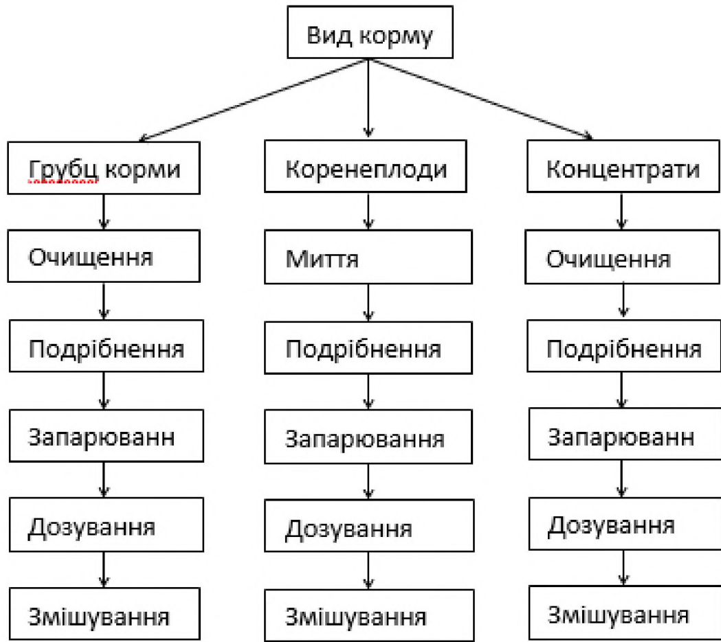
Рисунок 2.4. – Технологічна схема приготування кормів до згодовування.
