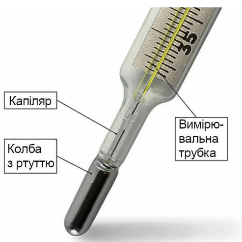
Рисунок 1.1 – Конструкція рідинного термометра [10]
