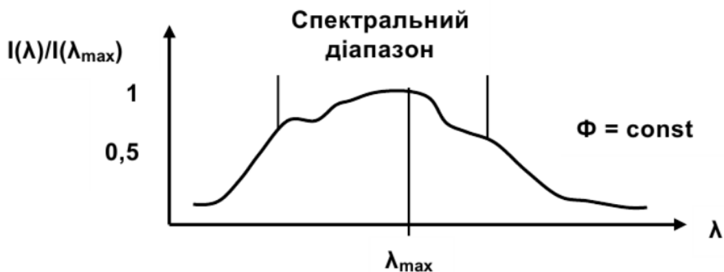
Рисунок 2.11. Спектральна характеристика фоторезисторів
