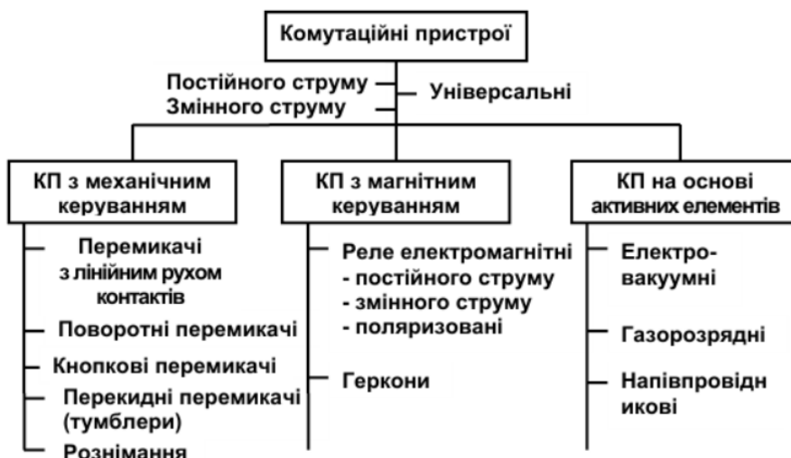
Рисунок 5.1 – Структура комутаційних пристроїв
