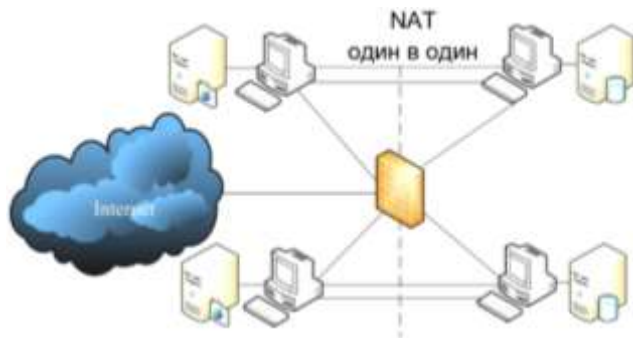
Рисунок 11.1 – Встановлення брандмауера у локальній мережі
