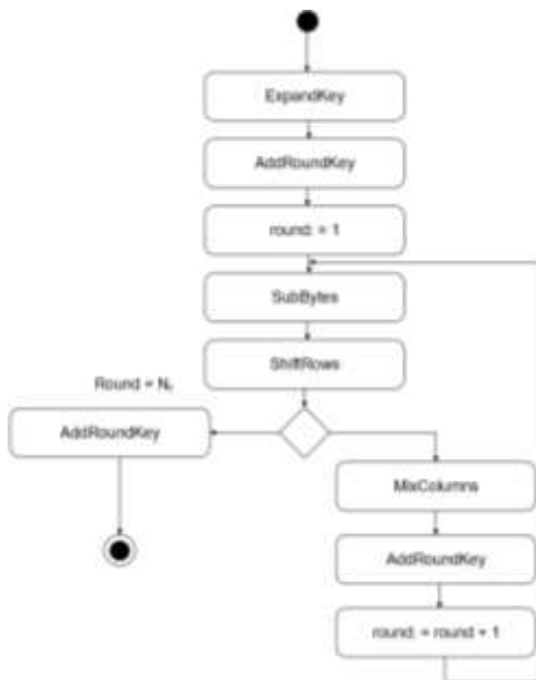
Рисунок 7.7 – Блок-схема процесу шифрування алгоритму AES
