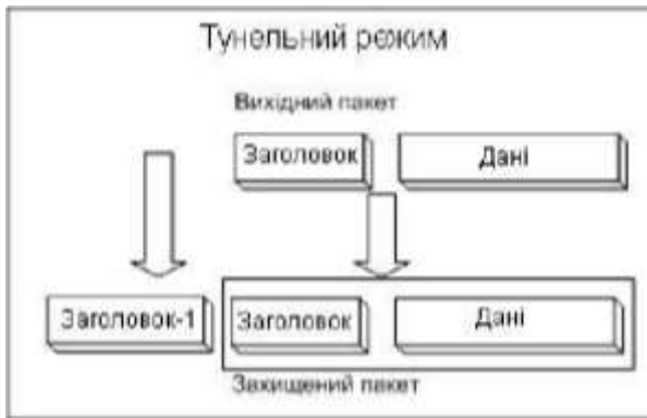
Рисунок 11.10 – Схема захисту пакета даних у тунельному режимі функціонування протоколів АН і ESP
