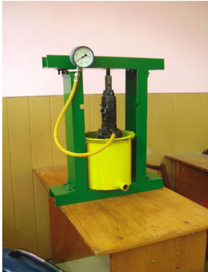
Рисунок 3.3 Фото дослідної установки для дослідження зневоднення сапропелю природньої вологості
