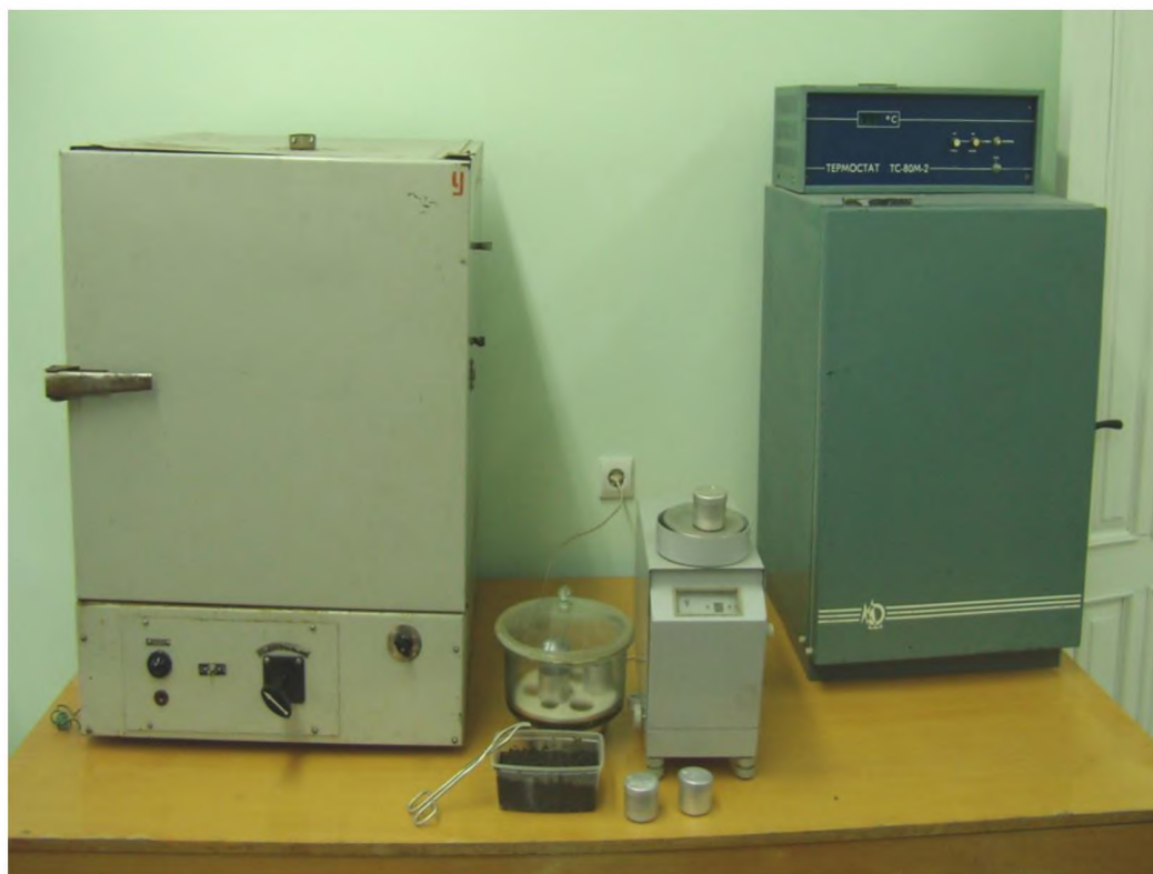
Рисунок 3.1 Прилади та обладнання для визначення вологовмісту та вологості сапропелю
