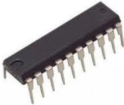
Рисунок 2.2 - Мікроконтролери U1 типу AT90S2313 фірми Atmel
