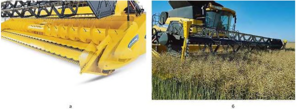
Рисунок 1.4. - Схема збільшення довжини платформи (а) та комбайн NEW HOLLAND з жаткою Varifeed при збирання ріпаку
