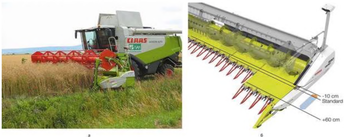
Рисунок 1.3 - Загальний вид (а), схема збільшення довжини платформи (б) жатки моделі VARIO
