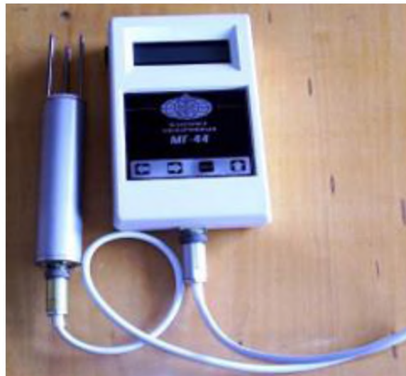
Рисунок 3.2 – Електронний вологомір МГ-44
