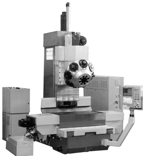
Рисунок 1.1 – Верстат вертикально-фрезерний з ЧПУ МА-655ЛН
