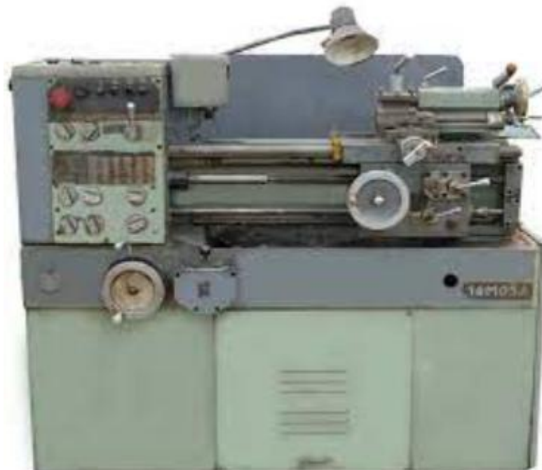
Рис. 4.1 - Верстат мод. 16М05А токарний, патронно-центрної особливо високої точності
