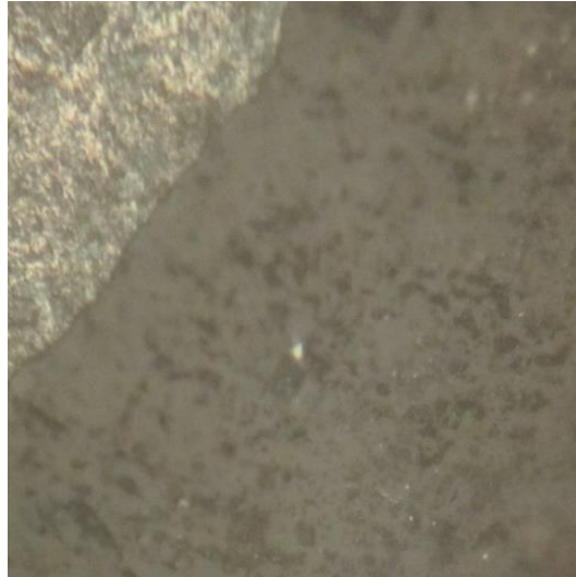
Рисунок 3.15 – Відбитки індентора при визначенні мікротвердості ПЕО-покриття, \times 250
