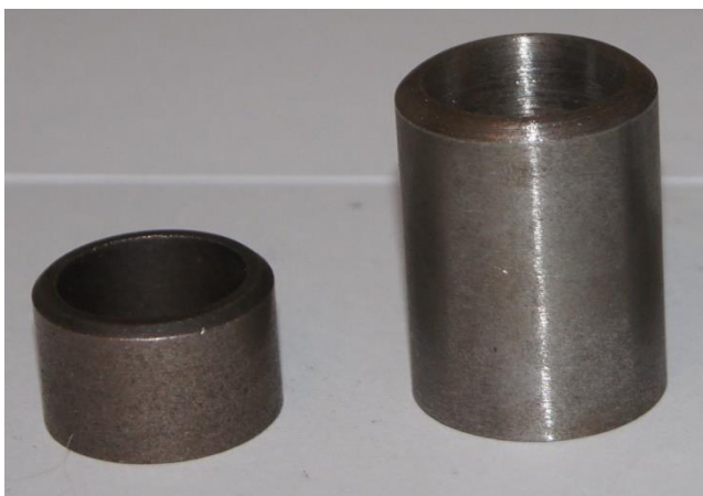
Рисунок 2.1 – Спресовані деталі зі складу порошкової суміші:
