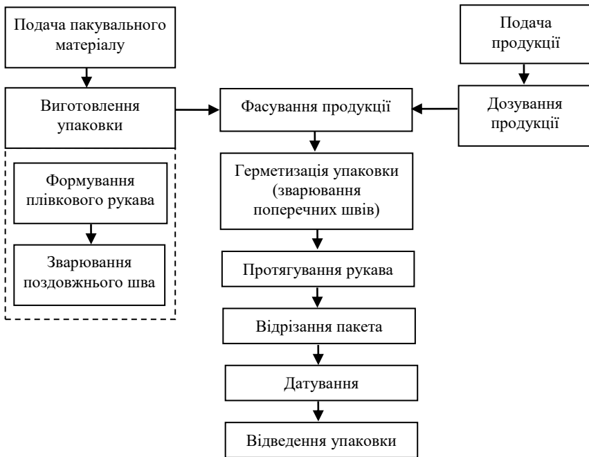
Рисунок 3.1 – Послідовність технологічного процесу пакування сипкої продукції в полімерні пакети
