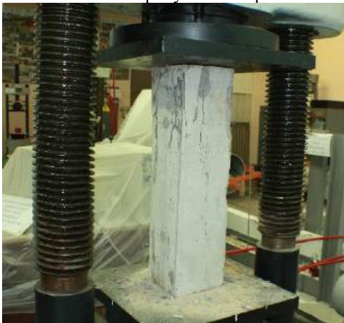
Рис. 1.5. Характер руйнування бетонної призми при стиску
