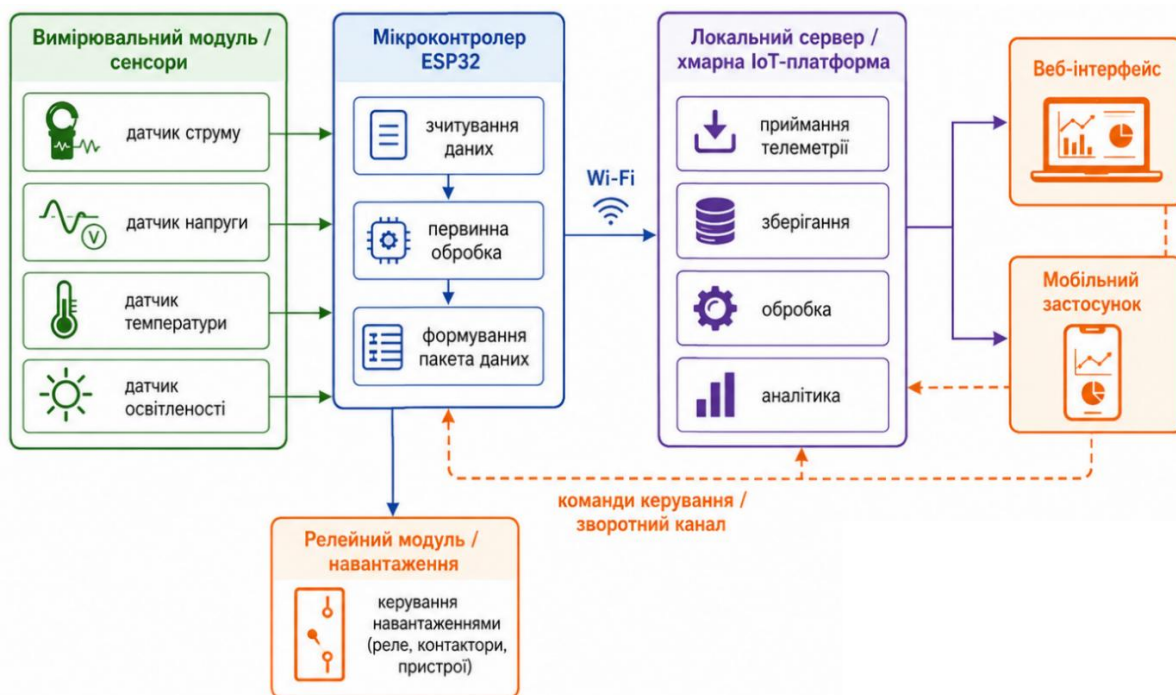
Рисунок 1.6 – Схема передавання даних у системі енергомоніторингу розумного будинку [5]
