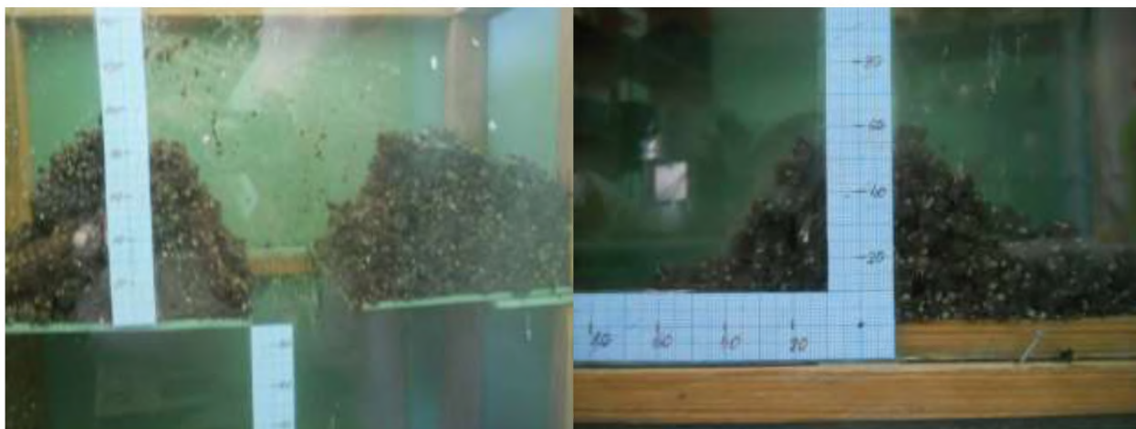
Рисунок 4.1 Процес дослідження кута природного відкосу суміші сапропелю (70%) та суперфосфату (30%).
