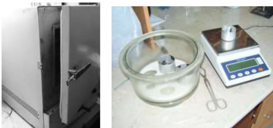
Рисунок 3.3 Обладнання для дослідження вологості: сушильна електрошафа СНОЛ – 3,5.3,5.3,5/3 ИЗ; лабораторні ваги ТВЛ 0,5; бюкси
