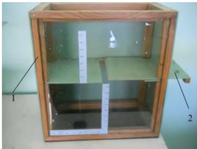
Рисунок 3.2 Ящик для визначення кутів природного відкосу: 1 – ящик; 2 – заслінка.
