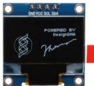
Рисунок 2.12 – OLED дисплей 0,96 дюйми 128 на 64 пікселі [28]
