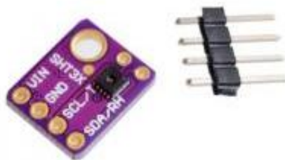
Рисунок 2.6 – Датчик температури та вологості SHT30 [16]
