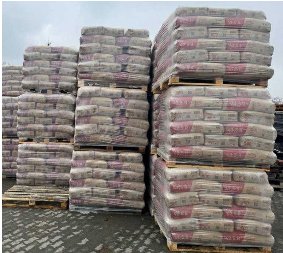
Рисунок 2.3 – Розміщення цементно-піщаної суміші у мішках на піддонах
