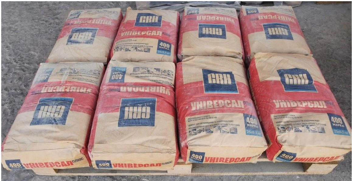
Рисунок 2.2 – Розміщення одного ярусу цементно-піщаної суміші у мішках на піддоні
