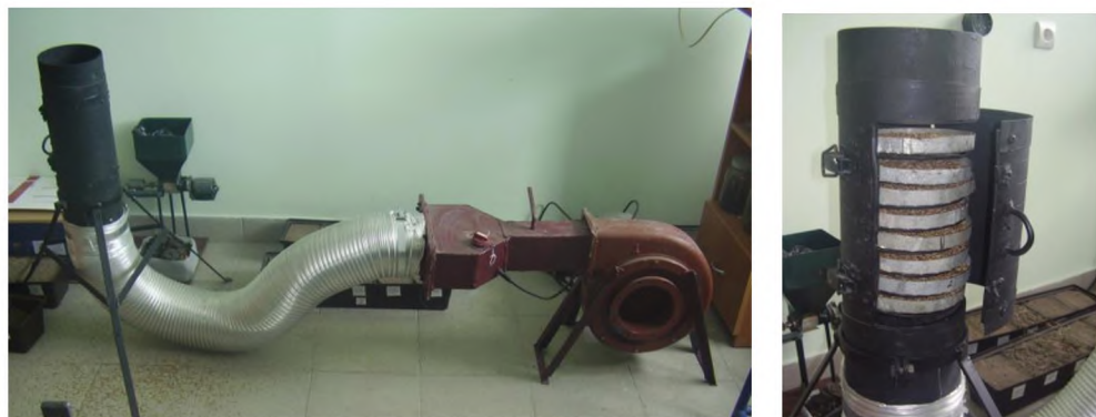
Рис. 3.4. Лабораторна установка для дослідження процесу сушіння сипкого матеріалу
