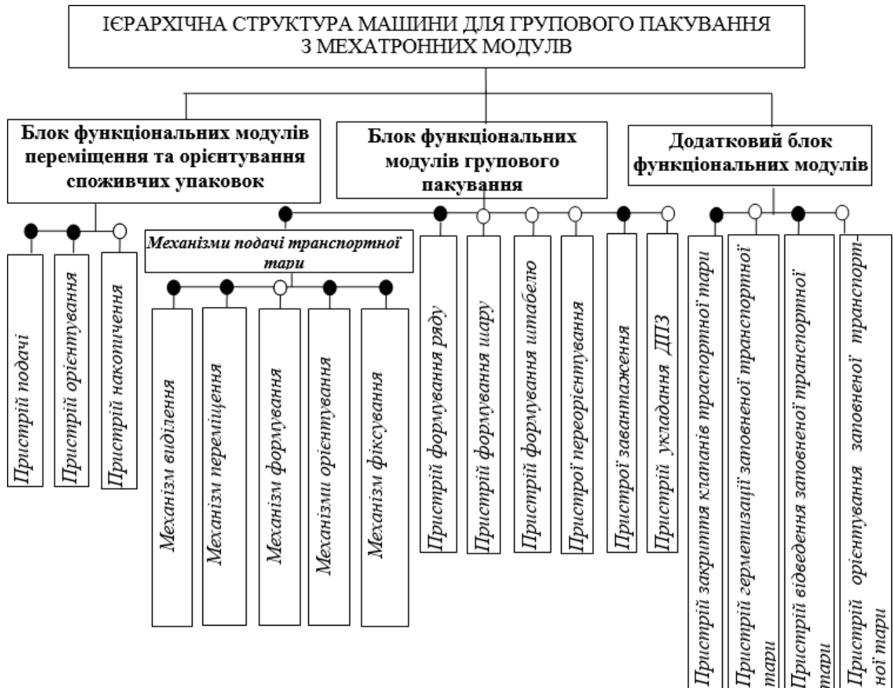
Рисунок 3.7 – Узагальнений граф компоновки структури машини для групового пакування з мехатронних модулів
