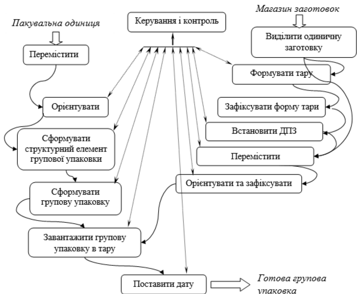
Рисунок 3.3 – Логічні зв'язки взаємодії між функціональними модулями в технологічному процесі групового пакування в транспортну тару
