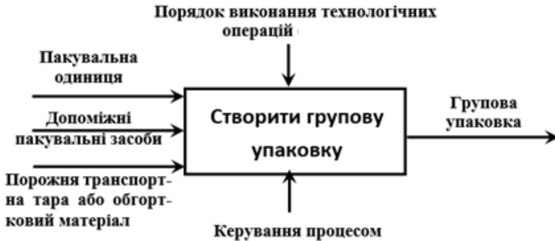
Рисунок 3.2 – Структурна схема поєднання матеріальних та інформаційних потоків під час виконання технологічного процесу групового пакування
