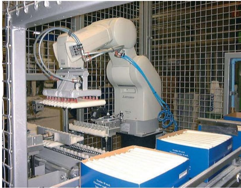
Рисунок 1.3 – Схема робототехнічної системи для формування групової упаковки із пакувальних одиниць циліндричної форми в картонні ящики
