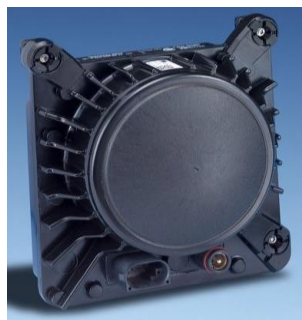
Рисунок 1.4 – Радар системи попередження про зіткнення EATON-VORAD Collision Warning System [12]
