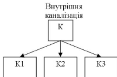
Рисунок 5.8 – Класифікація внутрішньої каналізації: К1 – побутова каналізація («господарсько-фекальна каналізація»); К2 – дощова каналізація («атмосферна»); К3 – виробнича каналізація
