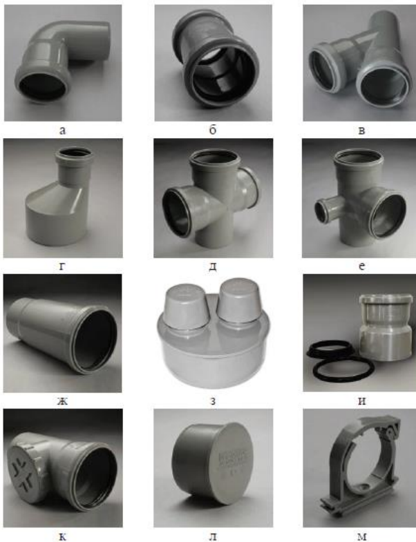
Рисунок 5.12 – Фасонні частини з пластику: а – відведення; б – муфта дворозтрубна; в – трійник; г – перехід; д – хрестовина одноплощинна; е – хрестовина двоплощинна; ж – компенсаційний патрубок; з – вакуумний
