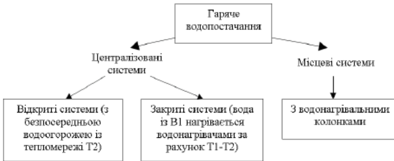
Рисунок 5.7 – Класифікація гарячого водопроводу Т3-Т4 за розташуванням джерела теплоти
