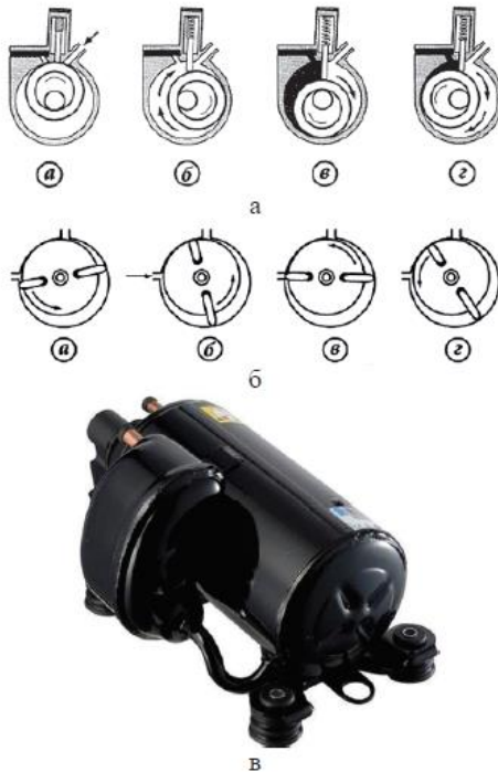
Рисунок 4.25 – Ротаційний компресор: а – із стаціонарними пластинами; б – з пластинами, що обертаються; в – зовнішній вигляд ротаційного компресора
